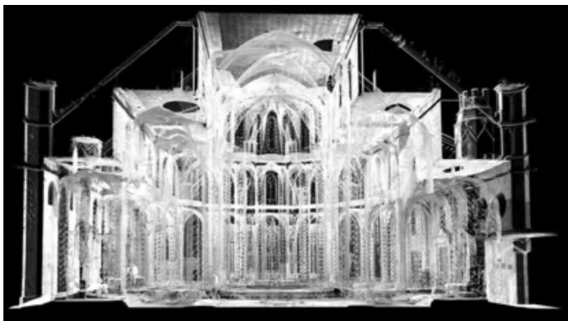
Figura 80. Láser escáner terrestre (TLS) catedral Tortosa.
