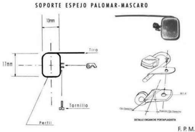
Fig. (17) Diseño del espejo nasolaterovisor de Palomar Mascaró (2008), que puede ser adaptado a cualquier montura metálica.
