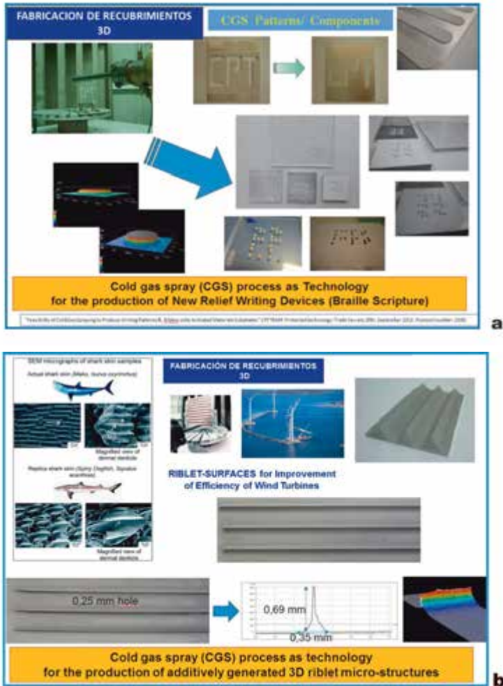
Fig 48. Perfiles 3D sobre sustratos de materiales diversos a) Escritura "Braille" b) Decoración de Palas de aerogeneradores para mejora de eficiencia energética. Realizados en el Centro de Proyección Térmica (CPT).
