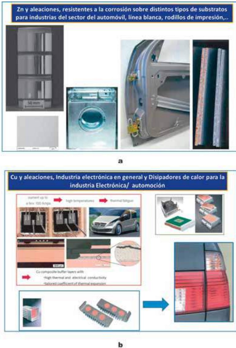
Fig 38. Algunos ejemplos de recubrimientos industriales de Proyección Fría: a) De Zn y aleaciones, resistentes a la corrosión sobre distintos tipos de sustratos para industrias del sector del automóvil, línea blanca, rodillos de impresión. b) Cu y aleaciones, Industria electrónica en general y Disipadores de calor para la industria de automoción.
