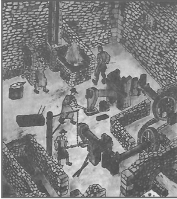
Fig 5. Esquema de una instalación del hierro en la Farga Catalana. Horno bajo; golpeo del “masser” y forja de piezas de hierro. Dibujo incluido en la obra “La Farga Catalana” del Dr. Pere Molera (1980).
