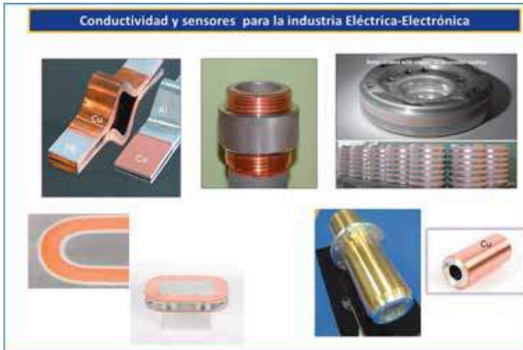
Fig 39. Algunos ejemplos de recubrimientos de Proyección Fría: Contactores para la Industria eléctrica y electrónica; Recubrimiento de plata sobre recubrimientos de cobre y cobre sobre conectores de aluminio. Conductividad eléctrica y Sensores para la industria del coche eléctrico y trenes de alta velocidad.
