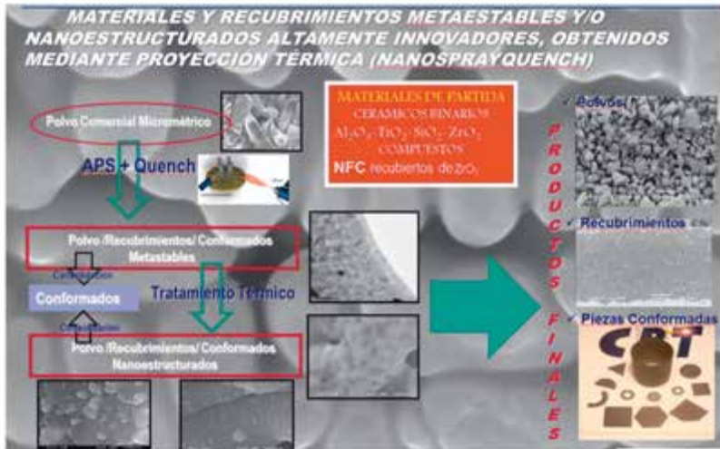
Fig 15. Cerámicas inteligentes: APS (plasma)+ QUENCH protocolo de trabajo y resultados: formación de polvos, recubrimientos y piezas de fabricación aditiva metaestables y su evolución a materiales nanocristalinos. Centro de Proyección Térmica (CPT)-UB.
