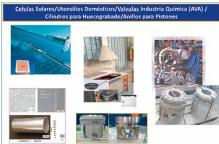
Fig 40. Algunos ejemplos de recubrimientos de Proyección Fría para: Aplicación en Células Solares. Utensilios domésticos. Cilindros. Anillos para Pistones. Sobre aleaciones ligeras de Mg, recubrimientos de Acero Inoxidable o de aleación ligera Al-12%Si. Válvulas de Tántalo.
