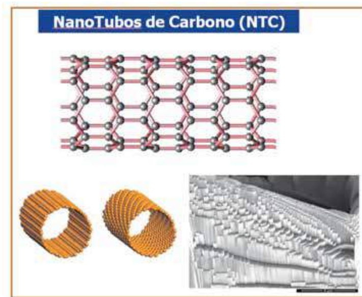
Fig 16. Esquemas de las características estructurales de los Nanotubos e Imagen SEM de Nanotubos de Carbono. (Guilemany. 2017. Materialografía UB).
