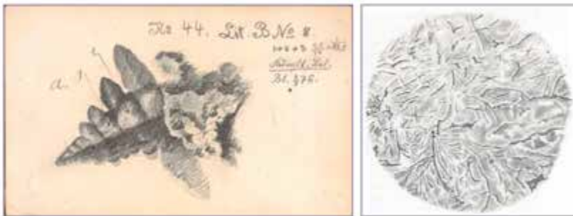
Fig 9. Dibujo de una dendrita de Adolf Martens, con anotaciones manuscritas y micrografía de Microscopía Óptica de una Fundición Gris con grafito laminar del propio Martens (1878).
