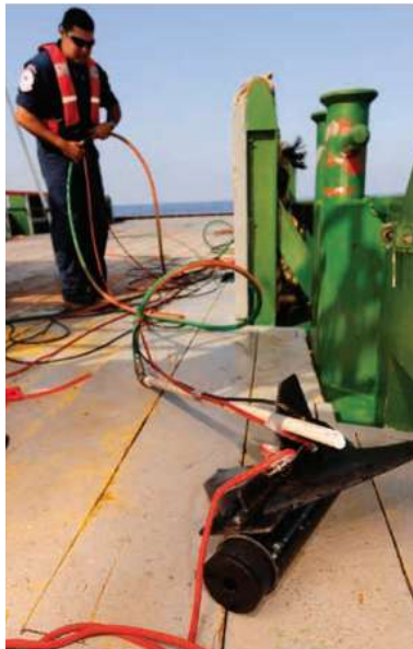
Figura 4.21: Preparación de un fluorómetro remolcado para medir la eficacia del dispersante en la mar.
