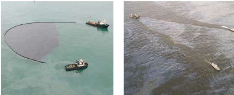
Figura 4.16: Izquierda, barrera inflable desplegada en configuración U. Derecha, barrera de cortina en configuración en V
