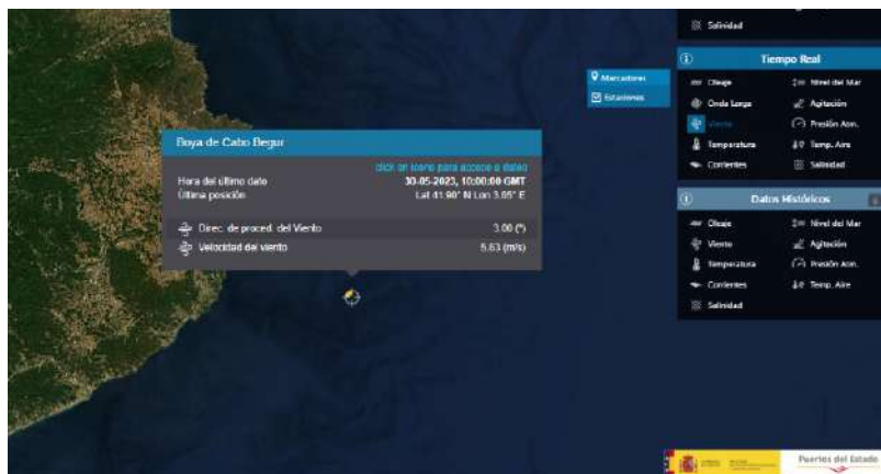
Figura 8.8: Medición de viento en la Boya de Cabo de Begur
