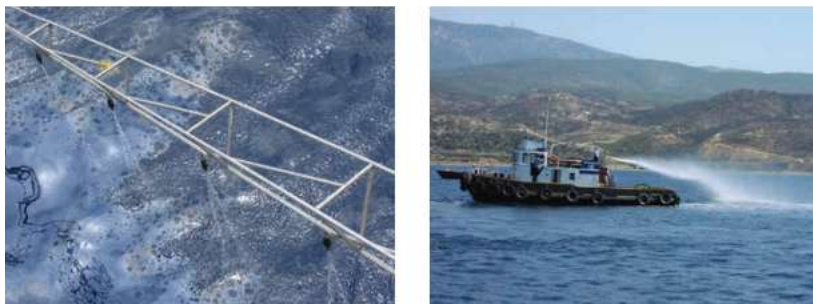
Figura 4.19: Aplicación de dispersante desde una embarcación
