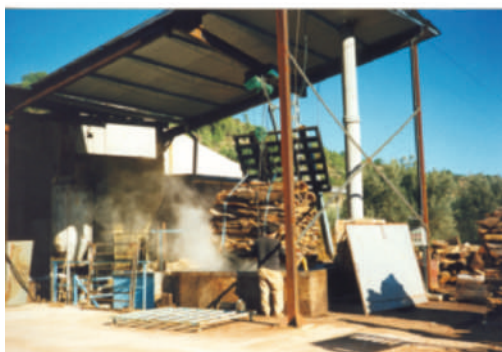
Proceso de hervido de las planchas de corcho
