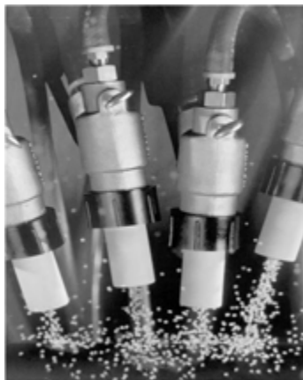
Figura 4.11. Máquina de shot blasting
