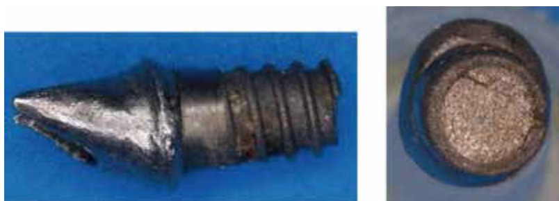
Figura 5.21. Implante dental de titanio fracturado
