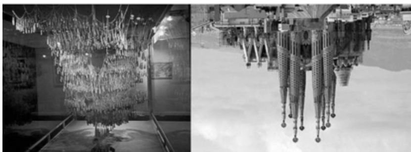
Fotografies 1.6 i 1.7. Model i prototipus de la basílica de la Sagrada Família (Google Images; http://estructurando.net/2013/11/21/gaudi-el-funicular-de-cargas-y-un-software-para-calcul-en-3d/ ).
