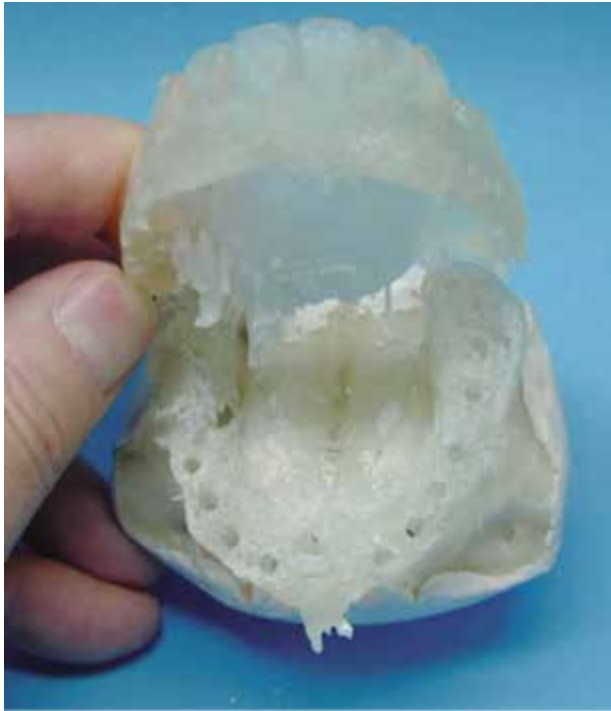
Fig. 7 Modelo estereolitográfico que reproduce el maxilar de un paciente mediante la información que proporciona el escáner y un programa especial de diagnóstico.
