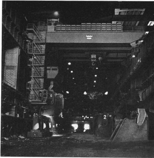
Fig. 3. — Grúa de colada de 475 Tm. con carro auxiliar de 80/20 Tm. y 22,5 m. de luz.
