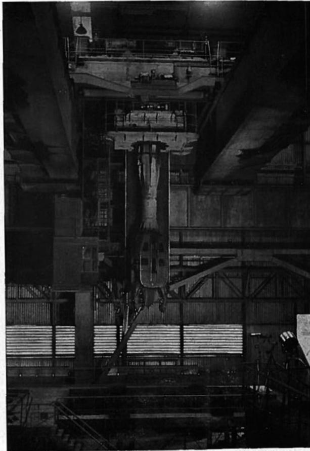
Fig. 12. — Grúa de horno de foso de 25 Tm. con guía única exterior con tenazas de cierre por fuerza.
